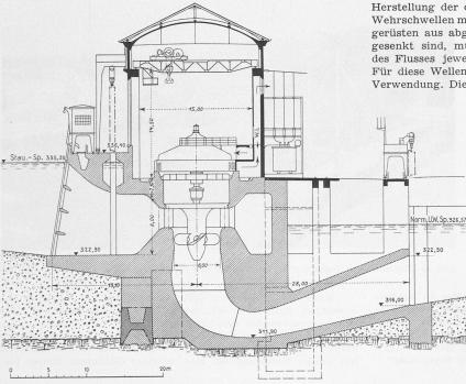
Abb. 4. Schnitt Ost-West durch das Krafthaus Reckingen. — Masstab 1:400
