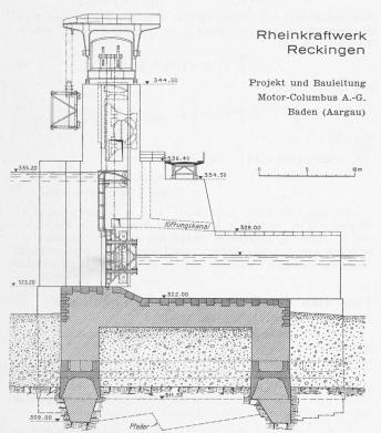
Abb. 3. Schnitt Ost-West durch eine Wehröffnung. — 1:400
