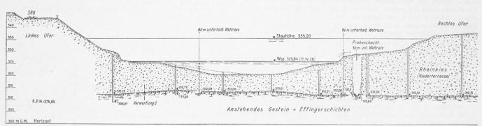
Abb. 5. Geologisches Profil in der Wehraxe, gemäss Ergebnis der eingetragenen Bohrungen. — Masstab 1:1000
