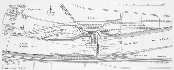
Abb. 1. Lageplan 1:6000 des Rheinkraftwerkes Reckingen, mit der zu späterer Ausführung vorgesehenen Schiffahrt-Schleuse
