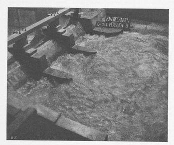
Abb. 16. Stauwehr Reckingen, Modell im Masstab 1:40. Versuch Nr. 8 entspr. einer Wassermenge von 1244 m³/s, wovon 834 m³/s durch die drei Wehröffnungen, verteilt auf 30  $^{\rm o}/_{\rm o}$ , 40  $^{\rm o}/_{\rm o}$  und 30  $^{\rm o}/_{\rm o}$  pro Oeffnung
