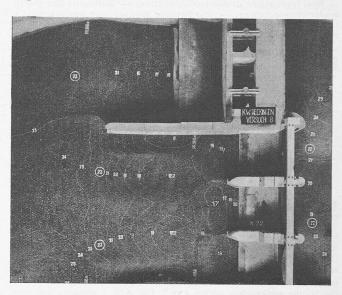
Abb. 17. Modell-Versuch Nr. 8. Kolkbildung (mit Meterkurven) nach 24-stündigem Dauerversuch, entsprechend 6,3 Tagen (24-stündig) in der Natur; die Höhenzahlen entsprechen der Natur
