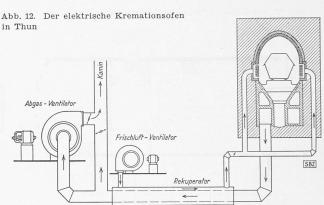
Abb. 11. Schema der Luft- und Verbrennungsgasführung zum elektrischen Kremationsofen System Brown, Boveri
