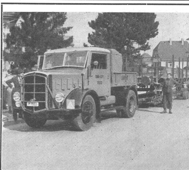
BERNA-Schlepper mit Vierrad-Antrieb mit Rollschemeel zum Abschleppen von beladenen Eisenbahnwagen im Totalgewicht von 40 Tonnen
