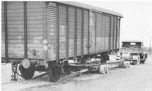
Abb. 1. Verlad eines Güterwagens auf den SBB-Rollschemel
