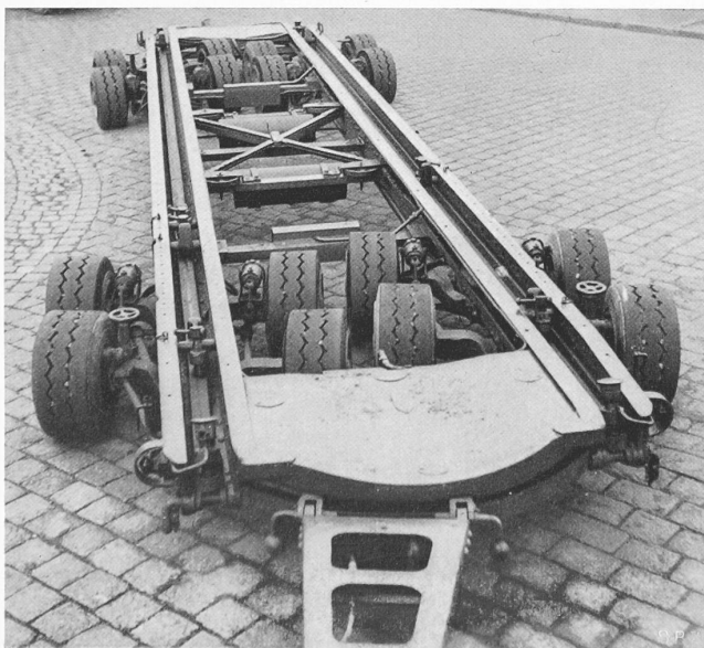
Abb. 4. Der SBB-Rollschemel in einer Kurve
