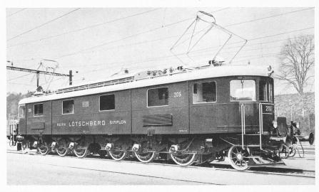
Abb. 2. Führertisch und -Sitz, sowie Gesamtansicht der elektrischen Lokomotive Ae 6/8 der BLS. 6000 PS, Vmax 75 km/h (Text s. Seite 32)
