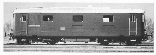
Abb. 3. Dieselelektrische Lokomotive Nr. 1001 der Schweizerischen Bundesbahnen, 1200 PS, V<sub>max</sub> 110 km/h
