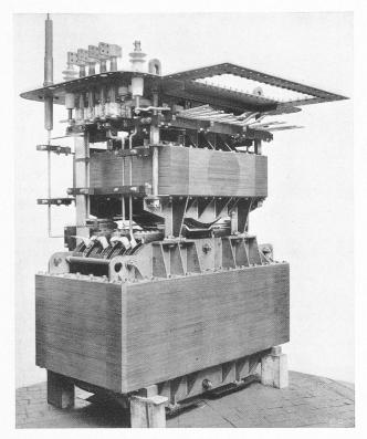
Abb. 13. Zusammengebaute Transformatorkerne
