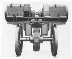
Abb. 11. Anordnung der Motoren, SLM-Einzelachsantrieb
