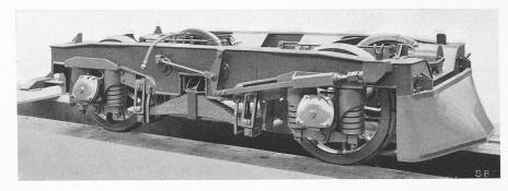
Abb. 7. Drehgestell der dieselelektrischen SBB-Lokomotive Am 4/4 Nr. 1001
