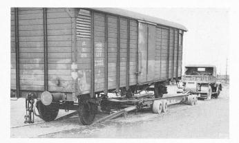
Abb. 1. Verlad eines Güterwagens auf den SBB-Rollschemel
