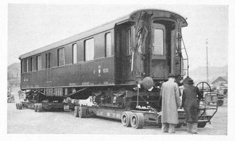
Abb. 11. Transport eines Vierachsers mit zwei Rollschemeln
