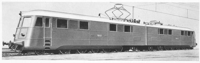
Abb. 15. Doppellokomotive Ae 8/14 der SBB für den Gotthard, 15 000 V, 162/3 Per., 12 000 PS, Vmax 110 km/h
