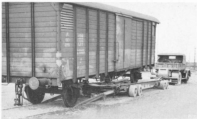
Abb. 1. Verlad eines Güterwagens auf den SBB-Rollschemel
