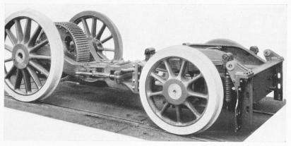
Abb. 10. Kombiniertes Drehgestell aus Lauf- und Triebachse
