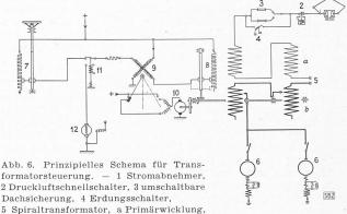
b sekundärseitige Spiralwicklung, 6 Triebmotoren,7 Spannungsteiler im Steuerkontroller, 8 Spannungsteiler im Transform.-Antrieb, 9 polarisiertes Relais, 10 Steuermotor, 11 Umschaltrelais, 12 Steuerdynamo
