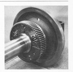
Abb. 4. Radsatz mit BBC-Federantrieb
