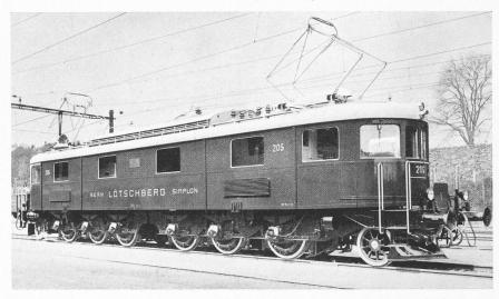
Abb. 2. Führertisch und -Sitz, sowie Gesamtansicht der elektrischen Lokomotive Ae % der BLS. 6000 PS, Vmax 75 km/h (Text s. Seite 32)
