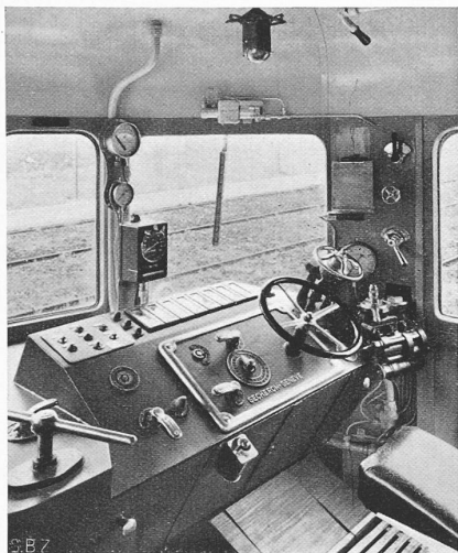
Abb. 2. Führertisch und -Sitz, sowie Gesamtansicht der elektrischen Lokomotive Ae \frac{6}{8} der BLS. 6000 PS, V_{\max} 75 km/h (Text s. Seite 32)
