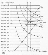
Abb. 7. Charakteristiken des MFO-Einphasenmotors. I Dauerstrom, II Einstundenstrom
