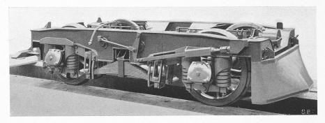
Abb. 7. Drehgestell der dieselelektrischen SBB-Lokomotive Am 4/4 Nr. 1001
