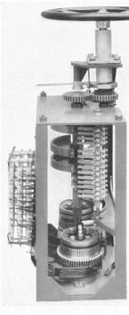
Abb. 9. Steuerkontroller
