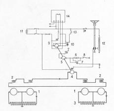
Abb. 8. Prinzipielles Schema für elektrische Bremsung. — 1 Anker, 2 Feld des Triebmotors, 3 Bremswiderstand, 4 Erregergenerator, 5 Einphasen-Serie-Motor, 6 Anlasswiderstand zum Einphasen-Serie-Motor, 7 Anlasschütz, 8 Anlassschalter, 9 Beleuchtungsgenerator (bei Ausfall der Fahrdrahtspannung als Gleichstrommotor arbeitend), 10 spannungsabhängiger Verriegelungsschütz, 11 Akkumulatorenbatterie, 12 Magnetregulator im Steuerkontroller, 13 Verriegelungskontakt im Wendeschalter, 14 Beleuchtungsregler
