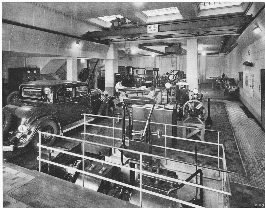
Abb. 3. Ansicht der Automobil-Prüfstände im Leichtmotoren-Laboratorium
