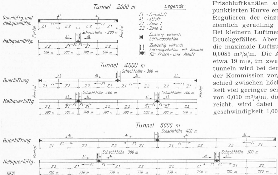
Abb. 8. Anordnung der Luftführung für unterteilte Quer- und Halbquerlüftung
