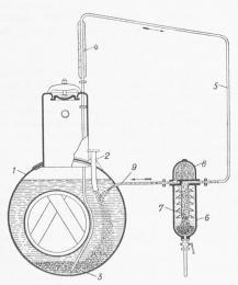
Abb. 2. Schema der Kesselwasserreinigung
