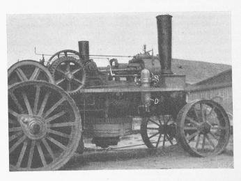
Abb. 1. Dejektor (D) am Kessel eines Dampflokomobils
