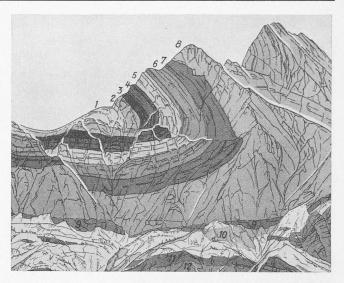
Abb. 5. Stereoautogrammetrischer Aufriss 1:18000 des Sichelkamms Legende: 1 Seewer-Schichten, 2 oberer Gault, 3 mittlerer, 4 unterer Gault, 5 oberer, 6 unterer Schrattenkalk, 7 Drusberg-Sch., 8 Hauterivien-Kalk, 9 Valangien-Kalk, 10 Valangien-Mergel, 11 Zementsteinschichten, 12 Malmkalk, Weiss = Quartär
