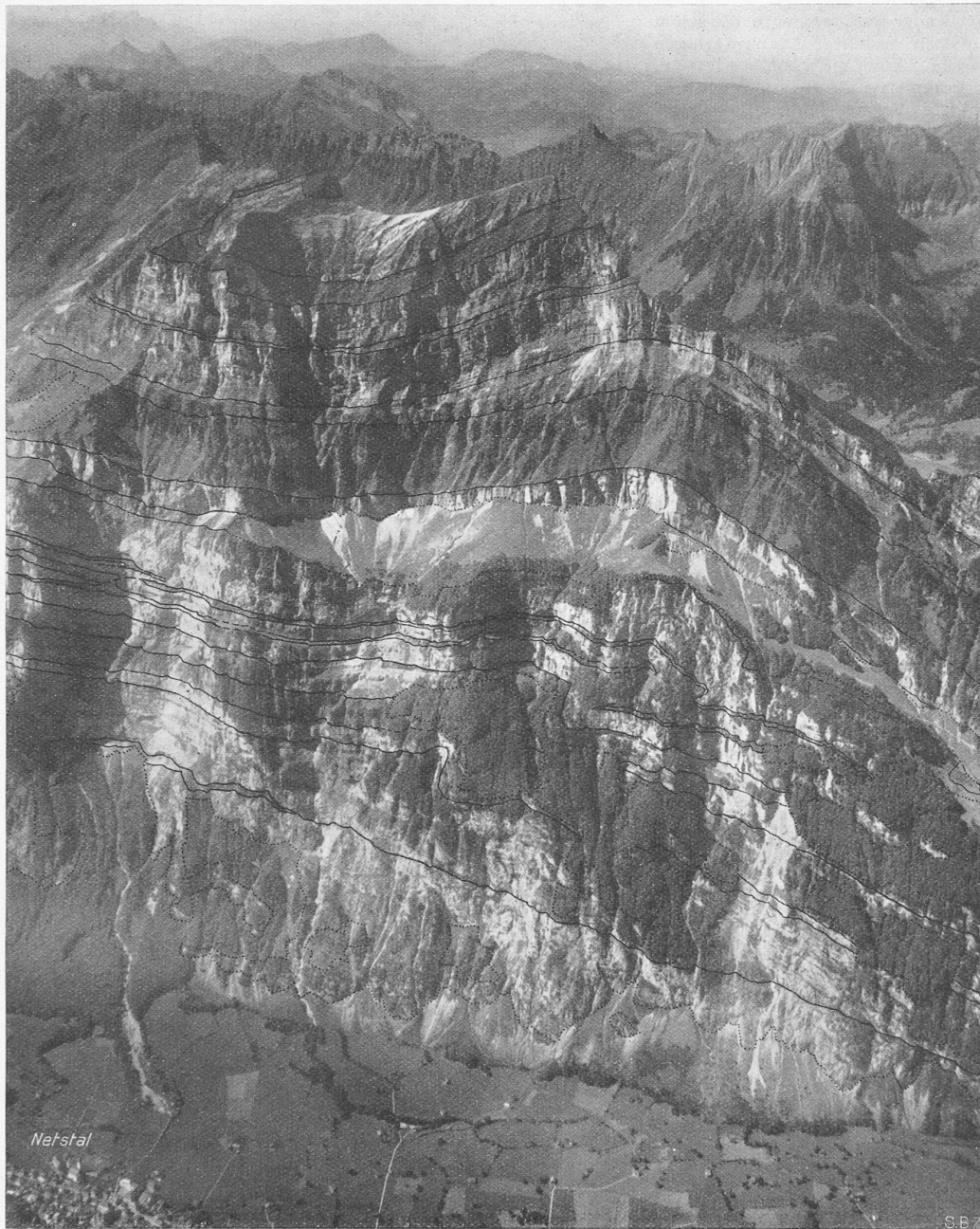
Abb. 1. Flieger-Messbild der Wiggis-Ostwand, mit geologischer Feldkartierung durch eingetragene Schichtgrenzen. Die im topographischen Grundriss (Abb. 3) nicht sichtbaren Stellen z. B. der untern Schicht 2 sind überhängend.
