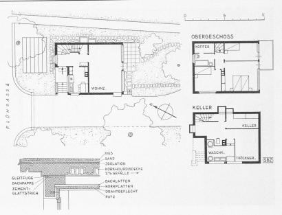
Abb. 12 bis 14. Ansicht, Grundrisse 1:300 und Konstruktionseinzelheit 1:30 des Gärtnerwohnhauses in Zürich. — Architekten FREY & SCHINDLER, Olten-Zürich
