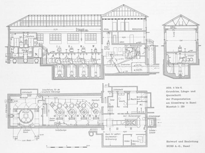
matoren 6000/500 Volt. mit natürlicher Lüftung, von 160 und 250 kVA Leistung über zwei unabhängige Sammelschienen. Diese können so gekuppelt werden, dass die Netz-Kurzschlussleistung auf rd. 3000 kVA begrenzt bleibt. Die Bedienung aller Niederspannungsapparate geschieht von der Schalttafel aus, wo auch der Fernmelder des Wasserstandes im Zulaufkanal montiert ist.
