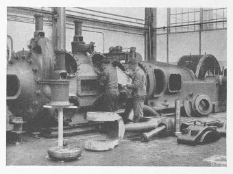
Abb. 2. Niederdruckteil eines Burckhardt-Hyperkompressors
