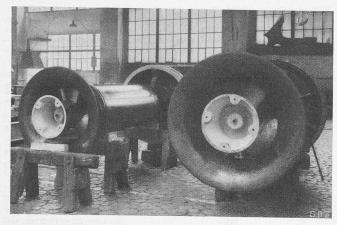
Abb. 9. Escher-Wyss-Schmutzwasser-Propellerpumpen
