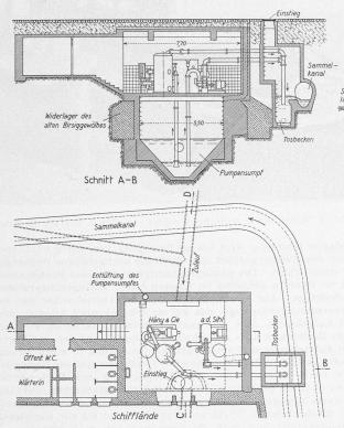
Abb. 1 bis 3. Grundriss und Schnitte 1:250 der Pumpstation bei der Schifflände in Basel
