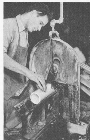
Schneiden von Rohr aus Presstoff mittels Crystolon-Trennscheibe
