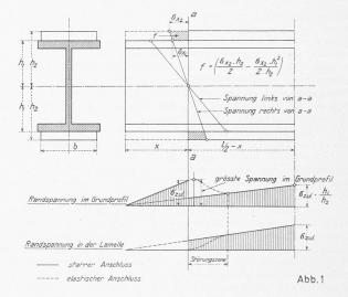
und den Längsschubkräften, die vom Grundprofil auf die Lamelle übertragen werden. Diese beiden Kräfte sollen für den einfachen Fall des freiaufliegenden Trägers mit Einzellast in Trägermitte (Abb. 2) berechnet werden.
