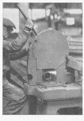
Schneiden von Dampfkesselrohr mittels Elektrokorund-Trennscheibe
