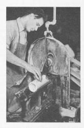
Schneiden von Rohr aus Presstoff mittels Crystolon-Trennscheibe
