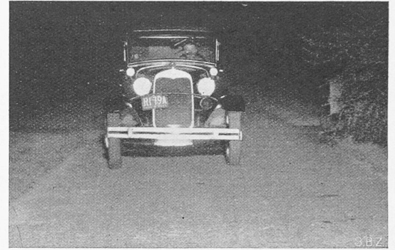
Abb. 2. Vermeidung der Blendwirkung bei vollem Polaroid-Scheinwerferlicht, Aufnahme durch Polaroidfenster
