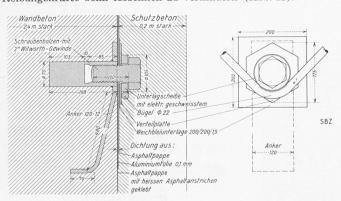
Abb. 11. Verankerung des Schutzbetons, durch die Dichtung wasserdicht hindurchgeführt. Masstab 1:10
