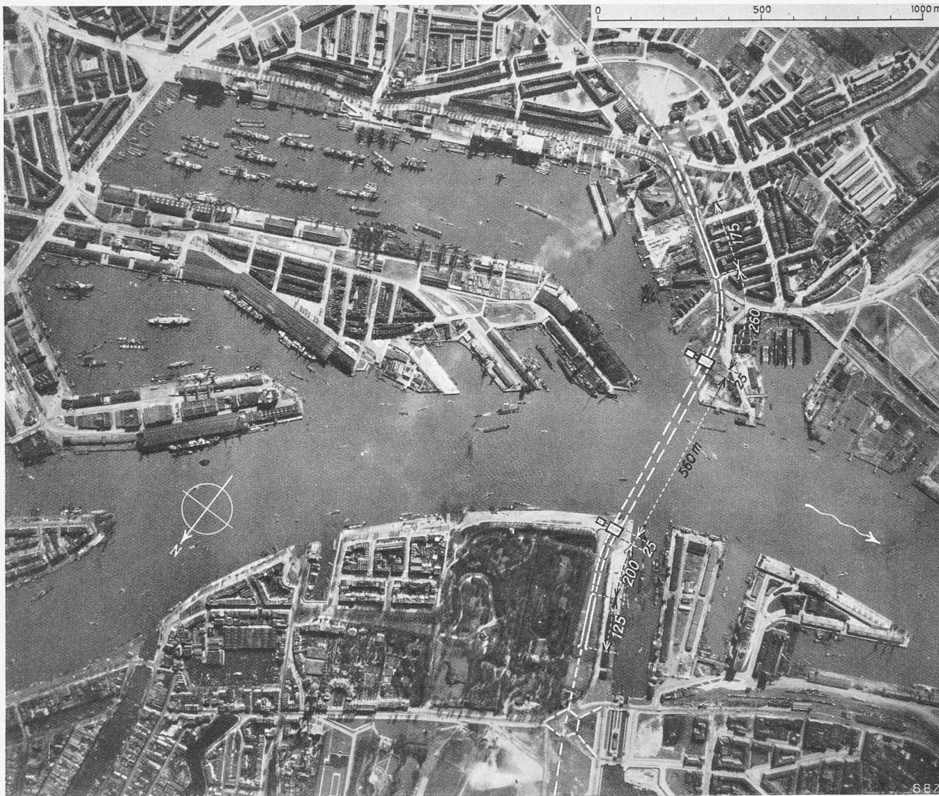
Abb. 1. Rotterdam, Blick auf die Neue Maas mit eingezeichnetem Verlauf des Tunnels und seiner Zufahrten. — Masstab 1:15 000. — Luft-Photo KLM Das grosse Becken im Südosten ist der Maashaven, das kleinere der Rijnhaven. Links unten der Altstadttrand, rechts davon der Heuvelpark
