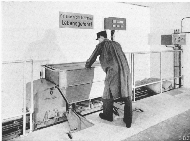
Abb. 5. Station Sihlpost. Die Ueberfahrbretter sind heruntergeklappt, der Einsatzwagen wird seitlich herausgezogen. Rechts die Steuerungs-Druckknöpfe, an der Wand die Signaltafel
