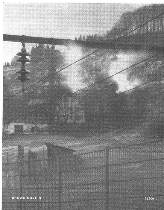
Versuchsanregung zur Bestimmung der Entionisie- rungszeiten von Kurzschlusslichtbogen bei Freilei- tungen
