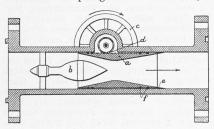
durch ein Armkreuz gehaltene Nadel b und eine als axial beweglicher Kolben ausgebildete Düse a mit venturiförmigem Strömungsquerschnitt eingebaut ist. Der Kolben ist an beiden Enden je nach Verwendungszweck mit
