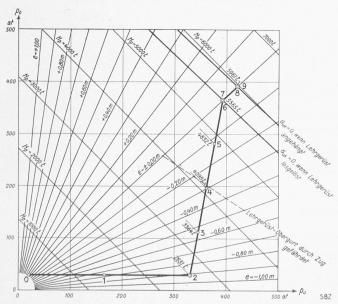
Abb. 4. Diagramm für  $H_p$  und e als Funktion von  $p_o$  und  $p_u$   $H_p = {\sf gesamte Pressenkraft}$ .  $e = {\sf Exzentrizit}$ ät von  $H_p$  in Bezug auf den Schwerpunkt des Betonquerschnittes im Scheitel.  $p_o, p_u = {\sf Betriebsdruck}$  der Pressen der obern bezw. untern Reihe
