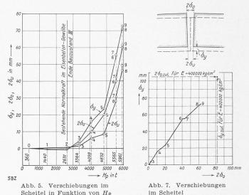
Das Eisenbetongewölbe arbeitete somit am Ende der Aufpressung vom Scheitel bis nahe an die Gewölbeviertel unabhängig vom Lehrgerüstbogen, wogegen die Verbundwirkung in Kämpfernähe durch das Aufpressen nicht gelockert worden ist. Dies wird ersichtlich aus den gemessenen Spannungsänderungen im Schei-
