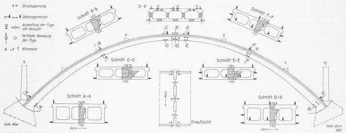
Abb. 2. Neue Aarebrücke Bern der SBB. Anordnung der Messinstrumente und mittlere Gesamtspannungen nach dem Aufpressen des Gewölbes Ansicht 1:900, Querschnitte 1:450, Spannungen  $1 \text{ mm} = 4.5 \text{ kg/cm}^2$
