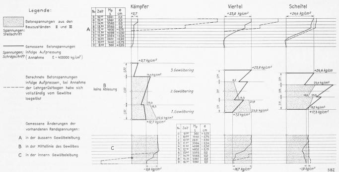
Abb. 9a. Veränderungen der Betonspannungen an der Gewölbestirnseite flussabwärts, Seite Wilerfeld
