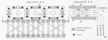
Abb. 1. Scheitelquerschnitt mit Gerüst der Aarebrücke Bern der SBB; 1:200
