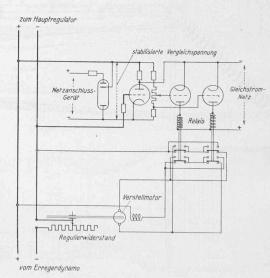
Abb. 11. Schema des Röhren-Spannungs- und Geschwindigkeitsreglers
