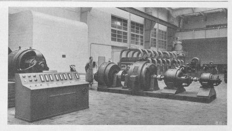
Abb. 9. Ward-Leonard Umformer Aggregat. Von links nach rechts: Gleichstromdynamo 700 kW, 550 V; Drehstrommotor 1000 PS, 6000 V; Gleichstromdynamo 100 kW, 230 V; Erregermaschine. Im Vordergrund links Schaltpult (dahinter der 900 PS-Motor des Ueberschallkanals)
