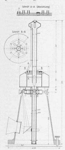
Abb. 15. Mikromanometer Prinzip Betz, mit abgeändertem Schwimmer und Optik. — 1:6
