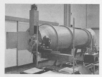
Abb. 20. Kleinwindkanal mit Installation für Flügelschwingversuche
