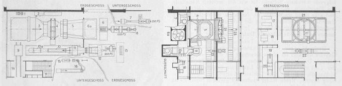
Abb. 1. Uebersichtspläne mit Schnitt des Institutes für Aerodynamik an der E. T. H., Zürich. — Masstab 1:400
