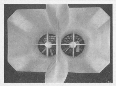
Abb. 6. Axialgebläse mit den Diffusoren, im Hintergrund Umlenkschaufeln
