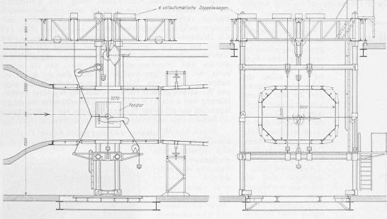
Abb. 13. 6-Komponenten-Waage mit eingebautem Flugzeugmodell. Waagen 1+2= Widerstand, 1-2= Moment um die Flugzeug-Hochaxe, 3+4+5= Gesamtauftrieb, 3-4= Moment um Längsaxe, 5= Moment um die Queraxe, 6= Seitenkraft. (Die an Drähten befestigten Modelle werden in Rückenlage eingebaut, damit die zu messenden Kräfte im gleichen Sinne wirken, wie das Modellgewicht, wodurch die Aufhängedrähte stets gespannt bleiben.)
