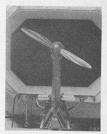
Abb. 19. Original-Holzpropeller (⊘ 1,20 m) eines Leichtflugzeugs, auf Pendelstütze im offenen Luftstrom, Benzinmotor-Antrieb mit Seidenbandriemen
