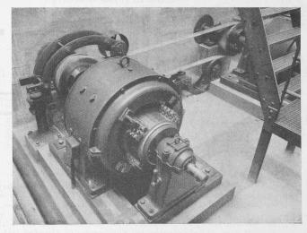
Abb. 7. Gleichstrom-Antriebmotoren mit Seidenband-Synchronisierung
