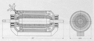
Abb. 18. Schnellaufender Drehstrommotor, zwecks Momentmessung drehbar gelagert. N=2,5 PS, n=15000 U/min. — Masstab 1:4
