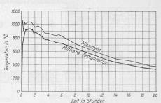
Abb. 4. Temperatur und Branddauer bei unbeschränkt vorhandenem Brennstoff
