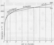
Abb. 3. Einheitstemperaturen für Brandversuche verschiedener Länder
