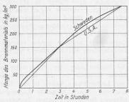
Abb. 6. Menge des brennbaren Materials und Branddauer
