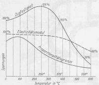
Abb. 1. Festigkeitsverhältnis von St. 37 bei höhern Temperaturen
