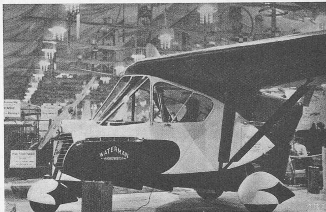
Abb. 5 und 6. Waterman Arrowbile. Geeignet für Strassen- fahrt, indem die Flügel leicht abnehmbar sind und das Bugrad steuer- bar ist entsprechend der Betätigung der Sei- tensteuerflächen, die an den Flügelenden sitzen.
