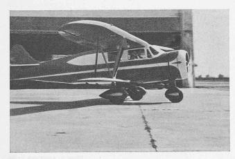
Abb. 1. Fünfplätziges Reiseflugzeug Waco N mit Bugrad, Spannweite 10,6 m, Länge 8,2 m, 300 PS,  $\nu=250$  km/h, Steigfähigkeit 4,1 m/sec, Nutzlast 620 kg
