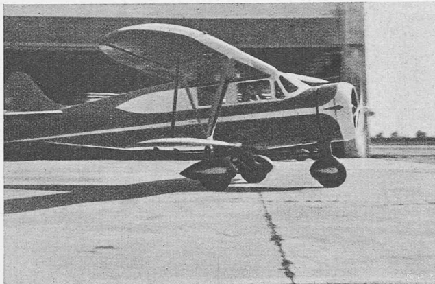
Abb. 1. Fünfplätziges Reiseflugzeug Waco N mit Bugrad, Spannweite 10,6 m, Länge 8,2 m, 300 PS, v = 250 km/h, Steigfähigkeit 4,1 m/sec, Nutzlast 620 kg
