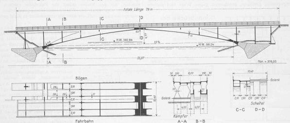
Abb. 11. Arvebrücke bei Vessy (Genf). Entwurf Ing. ROB. MAILLART. — Baukosten (1936/37) rd. 100 Fr./m². — Masstab 1:500.
