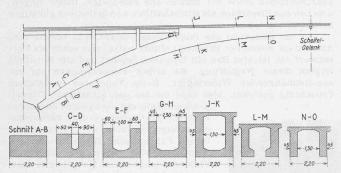
Abb. 6. Querschnitt-Verlauf des Rippenbogens. -1:200Abb. 4 bis 8 nach «Bautechnik» 1938. Nr. 40!41
