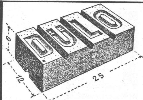
Nagelbar, schraubar, volumenbeständig, binden mit dem Mörtel ab. Unterteilbar in  $\frac{1}{8}$ ,  $\frac{1}{4}$ ,  $\frac{1}{2}$  und  $\frac{3}{4}$  Steine. Säurenfrei. Beste Befestigungs-Hinterlage für Schreinerarbeiten. Speziell zum Versetzen im Eisenbeton für die Befestigung von Lattenrostern, Rohrleitungen etc.
