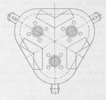
Abb. 2. Tysland-Hole-Ofen mit Elektroden im Dreieck
