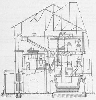
Abb. 3. Siemens Roheisen-Elektroofen nach Kauchtschischwili (nach «Stahl und Eisen» Bd. 58, Nr. 15, 1938).
