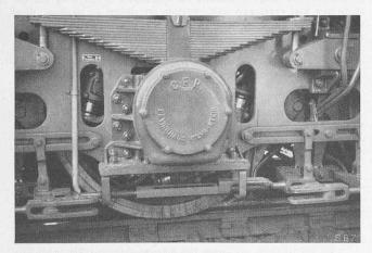
Abb. 2. Henschel-Lenkachse und Bremsgestänge
