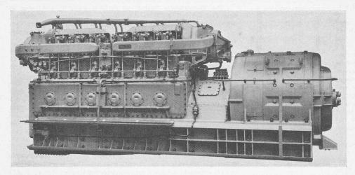
Abb. 5. Zwölfzylinder-Sulzerdieselmotor mit Brown-Boveri-Generator von 1255 kW Dauerleistung, 615 V, 2040 A (entsprechend 1900 PS Dauerleistung des Dieselmotors) bei 744 Uml/min
