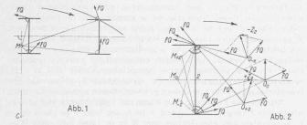
entgegengerichtet sein, siehe die schematische Abb. 1. M ist dann allen Rädern gemeinsam, wenn sie gleichen Laufkreisdurchmesser 2r, gleichen Raddruck Q und gleiche Winkelgeschwindigkeit um ihre eigene Drehaxe  $\omega_y$  haben und wenn alle Achsen genau parallel liegen. Das sei hier angenommen. Bei angetriebenen Achsen kann die gleiche Winkelgeschwindigkeit durch Kuppelstangen erreicht sein. Aus der Lage von M gewinnen wir P
