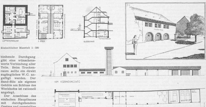
Der Anschluss des einfachen Hauptbaues mit durchgehendem Gesims und ungeteilter Dachfläche ist sehr zu begrüssen. Der Turm steht in gutem Abstand und gruppiert sich zu allen Teilen der Bauanlage günstig; ein Turm mit Beobachtungsraum wäre vorzuziehen. Die niedrigen
