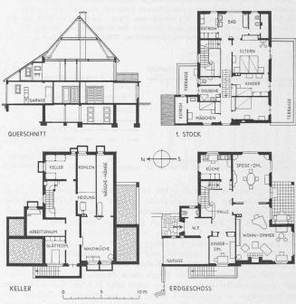
Abb. 2. Landhaus Dardel. Grundrisse und Schnitt 1:400
