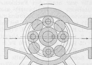
zwei Scheiben zur beidseitigen Lagerung der Zapfen. Eine Niederdruckpumpe mit vier Rollenpaaren und grosser Exzentrizität erzielte bei rd. 4 at Förderhöhe und einer Liefermenge von rd. 135 l/min einen volumetrischen Wirkungsgrad von 98%. Die vorliegende Konstruktion ist hauptsächlich für Schmieröl gedacht, kann aber auch für leichte und schwere Heiz- und Dieselöle verwendet werden («The Motor Ship», Sept. 1938).
