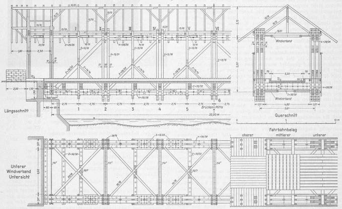
Abb. 1. Die Konstruktion der Schwarzwasserbrücke bei Rütiplötsch. — Masstab 1:175
