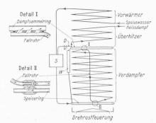
einen in sich geschlossenen Kreislauf hat, ist eine gegenseitige Störung ausgeschlossen. Da die Gemischgeschwindigkeit im obern Teil des Verdampfers 2,5 bis 3 m/sec beträgt, wird die Fallbewegung des Wassers nicht nur durch die Differenz der Dichte bewirkt, sondern noch durch die Trägheitswirkung
