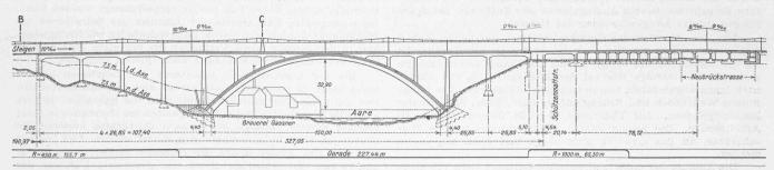
Abb. 1. Die neue Aarebrücke in der Lorrainehaldelinie der SBB (umgekehrt betrachtet wie obige Abb. 2!). — Masstab 1: 2500
