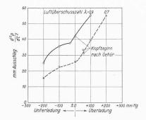
Abb. 2. Darstellung zweier Messreihen zur Bestimmung der Klopfgrenze von Olex-Fliegerbenzin mit  $0.06~{\rm Vol}~{\rm 0}/{\rm 0}$  Blei im CFR-Motor mit Verdichtung 1: 6
