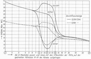
Abb. 9. Druckverlauf in einem Krümmer
