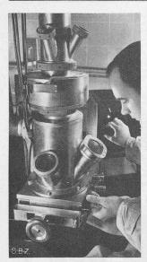
Abb. 4 (links). Elektronen-Uebermikroskop von Siemens
