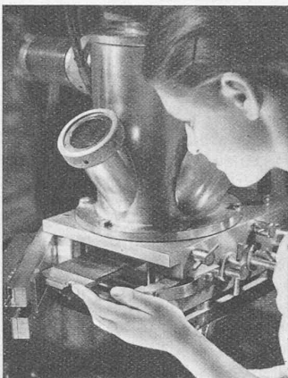
Abb. 5 (unten). Einschleusen einer photographischen Platte
