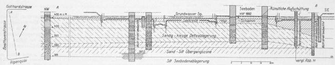
Abb. 4. Geotechnisches Profil durch den Baugrund des Kongressgebäudes in Zürich. (Untersuchung im Auftrag der Architekten M. E. Haefeli, W. M. Moser und R. Steiger.) Die nicht direkt beobachteten Profile sind Interpretationen von Proberammungen
