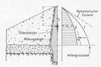
Abb. 15. Spannungserscheinungen im Dammkern
