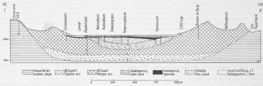
Abb. 2. Geologisches Querprofil NE-SW durch die Stadt Zürich, Längen 1:20000, Höhen 1:4000
