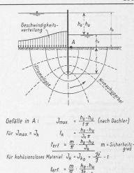
Abb. 7. Berechnung der gegen Grundbruch erforderlichen Spundwandtiefen bei unendlich ausgedehntem Grundwasserträger
