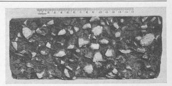
Abb. 14. Mischung von Ton und Splitt (Füllungsgrad f=2,5) Volumenverhältnis Kies: Ton = 0,87:1
