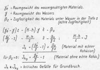
Abb. 6. Kritisches Gefälle für Grundbruch
