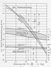
Abb. 12a. Spezif. Zusammendrückung und Porosität in Funktion des Druckes bei Gehängeton
