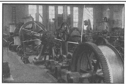
Grosse Seilschlagmaschine mif ca. 2300 kg Spulenfassung und Rückdreh-Vorrichtung für unsere Machart DEFAG-LAY
