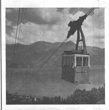
Festgefügter verschlossener Aufbau, Sicherheit gegen das Eindringen von Feuchtigkeit und gegen Rostbildung. Geringer Verschleiss des Seiles und der Laufräder. Ruhige, ungestörte, stossfreie Fahrt.
