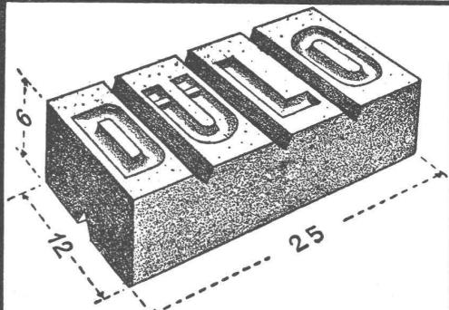
Nagelbar, schraubar, volumenbeständig, binden mit dem Mörtel ab. Unterteilbar in  $1/8$ ,  $1/4$ ,  $1/2$  und  $3/4$  Steine. Säurenfrei. Beste Befestigungs-Hinterlage für Schreinerarbeiten. Speziell zum Versetzen im Eisenbeton für die Befestigung von Lattenrostern, Rohrleitungen etc.
