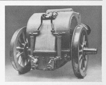
Abb. 4. Triebradsatz mit 400 PS-Dampfmotor und Getriebe
