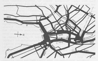
Abb. 6. Graph. Darstellung des Motorfahrzeugverkehrs am 16. Sept. 1936 während 74/2 Stunden. 1 mm Breite = 1500 Fahrzeuge (Cliché aus Band 110, Nr. 19, Seite 243)
