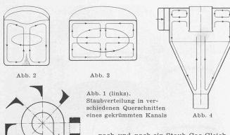
nach und nach ein Staub-Gas-Gleichgewicht mit erhöhter Staubkonzentration in den äussersten Schichten und abnehmender Konzentration gegen das Zentrum hin, wie aus Abb. 1 ersichtlich ist. Ist dieser Gleichge-
