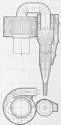
Abb. 8. Doppelzyklon-Abscheider
