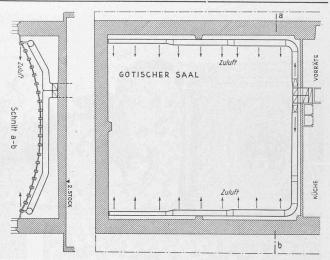
Abb. 19. Luftführung zum gotischen Saal 1:200
