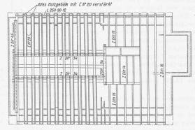
Abb. 17. Balkenlage des zweiten Stockes (Decke über dem gotischen Saal). — Masstab 1:300
